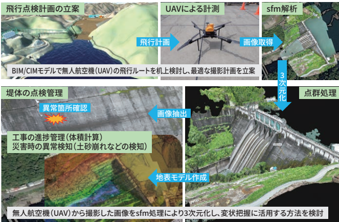
▲無人航空機 (UAV) を活用した工事管理の例
