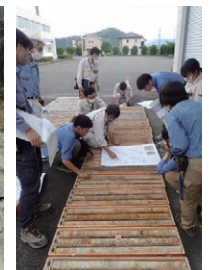
▲ダム事業のボーリングコア観察状況
