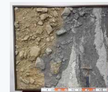
▲トレンチ調査による断層破砕帯の剥ぎ取り標本
