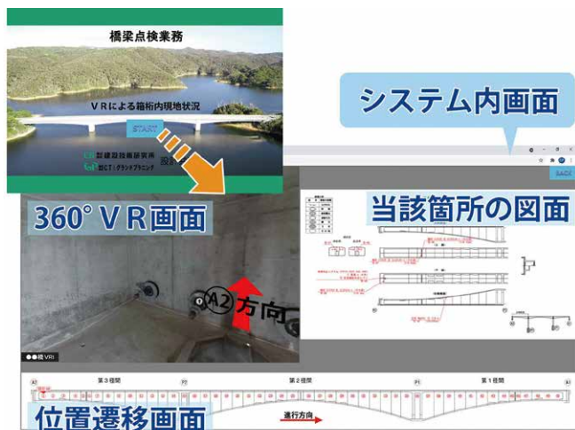
▲VRによる橋梁箱桁内点検結果表示システム
