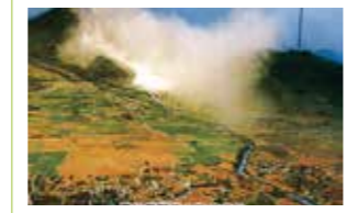
雲仙普賢岳のミニ模型による擬似火砕流 実験 (1992年) 建設省、土木学会から展示依頼があり、 新聞でも紹介された。その後、多くのミニ 模型を手掛けることになった。
