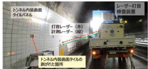
写真：レーザー打音検査装置
