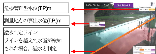
図-3 溢水監視モデルによる出力結果および算出
