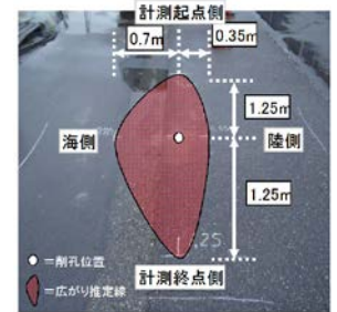
エプロン空洞化調査 (電磁波レーダ)
