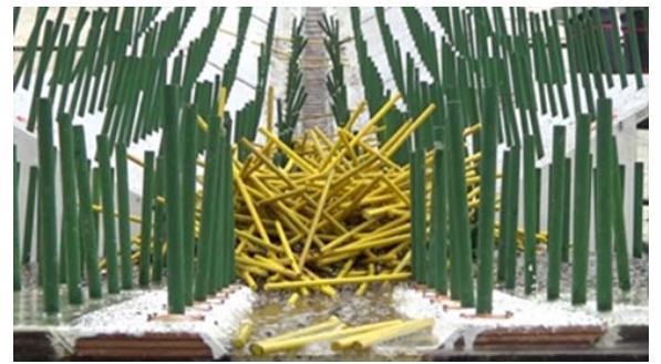
写真3 流木の堆積状況
