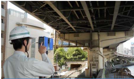
3Dスキャナによる形状計測
