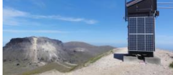
独立電源型の観測設備 (可視、赤外線カメラ)
