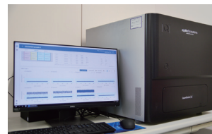
▲デジタルPCR 対象生物のDNAを低濃度でも高精度に定量
