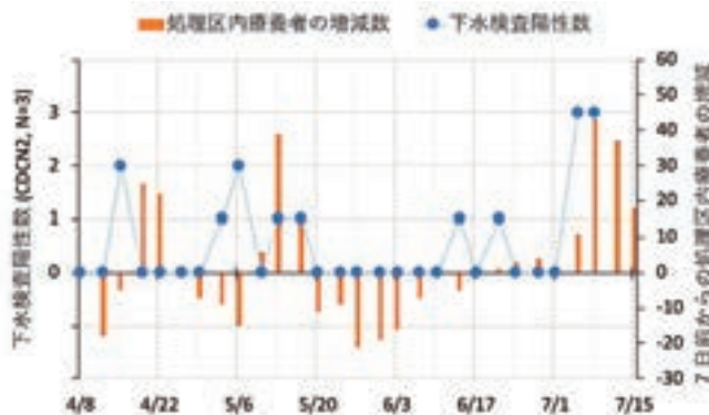
下水検査陽性数と療養者増減数の推移 下水検査の陽性数が増加するとその後に療養者数が増大する
